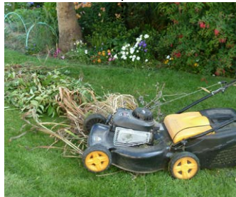
avec une tondeuse pour les branchages souples et fins (jusqu'à 1 cm de diamètre)
